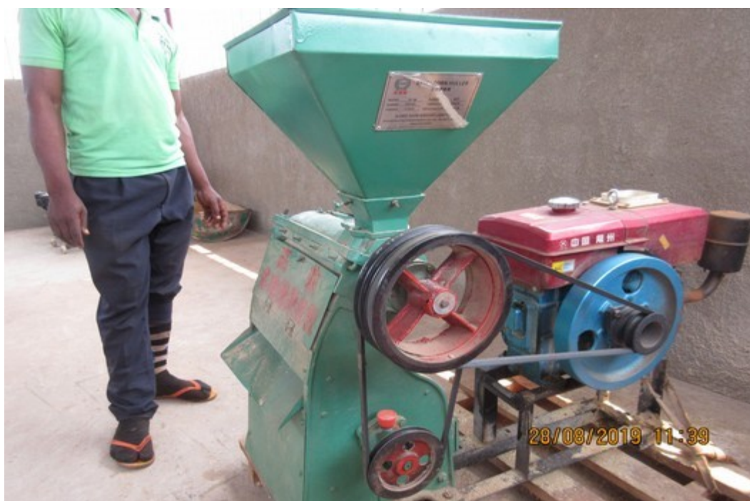
Décortiqueur de maïs grain pour l'obtention de farine de qualité à fine mouture
