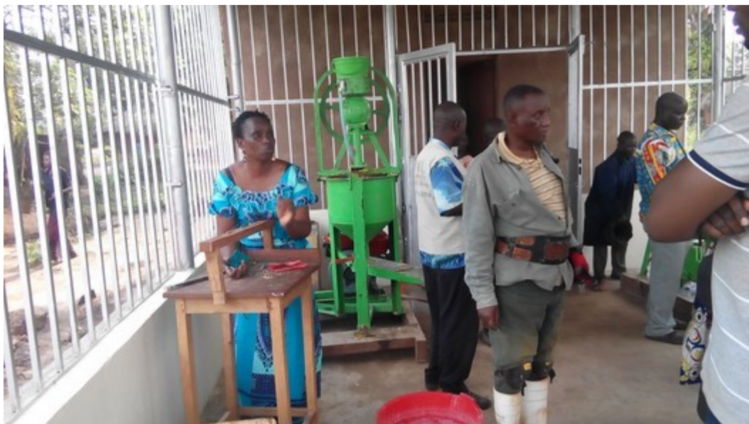
Mélangeur motorisé de pâte à savon de l'OPB PFP (au fond)
