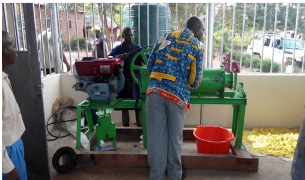
Boudineuse en action pour le traitement de la pâte à savon (OPB PFP à Luputa, territoire de Luilu)
