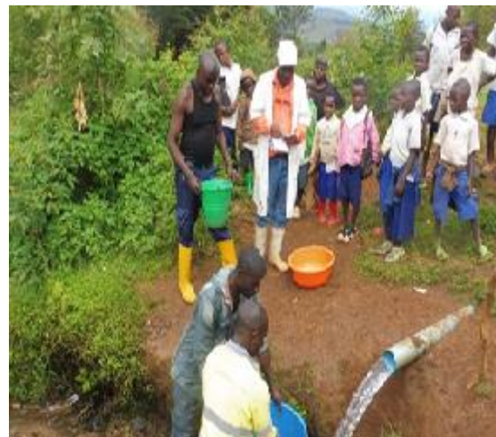
Mesure de débit sortie citerne de 30m 3 Mwendo
