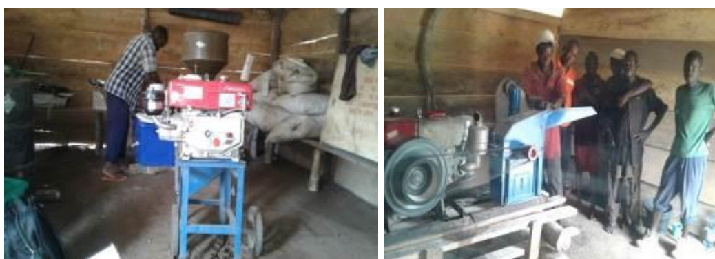
Equipements de conditionnement des ingrédients alimentaires des poissons au sein des centres d'alevinage (moulin à gauche, décortiqueuse de noix palmiste à droite)
