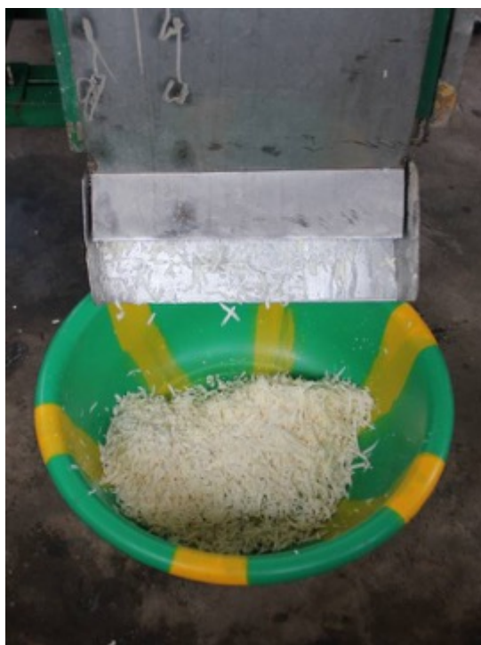
Trancheuse-râpeuse produisant des micro-cosettes fraîches à partir de tubercules de manioc
