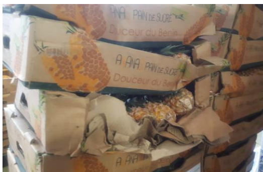
Problèmes des cartons lors du transport
