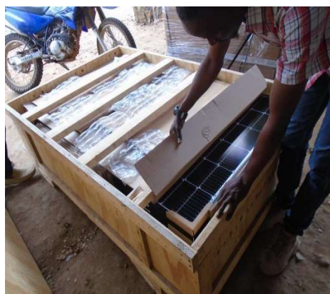
Modules solaires pour alimenter les dispositifs de production chlore (Via une électrolyse sur l'eau salée après injection de courant)
